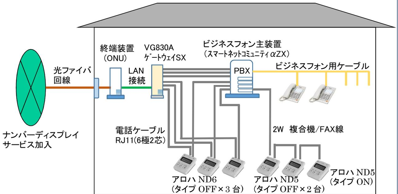
※VG830A ゲートウェイ SX「1」にて、アナログ信号に変換しビジネスフォン主装置の手前でアロハを接続
